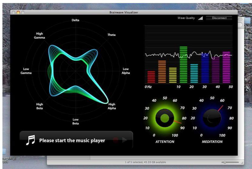
Figura 4. Interface do software do equipamento *Mindwave*<sup>®</sup> da *NeuroSky*<sup>®</sup>.
