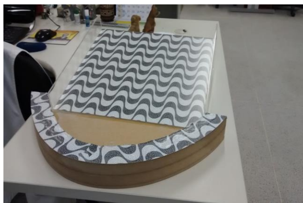
Figura 5: colar o poliuretano na parede parabólica
